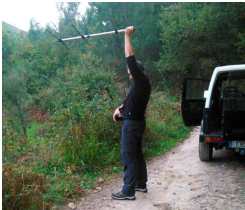
Figura 5. Seguimento de indivíduos radio-marcados com a antena Yaggi.
